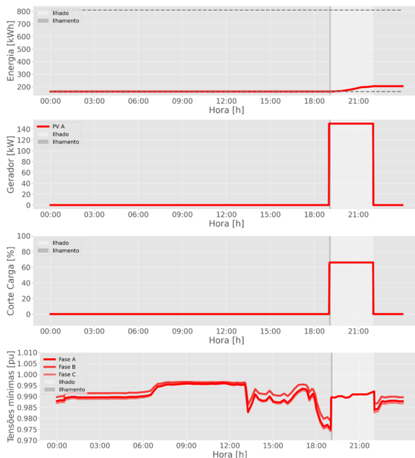
Figura 6 – Energia do BESS, potência no gerador, corte de carga e tensões no PAC: caso IV e contingência às 19 horas.
