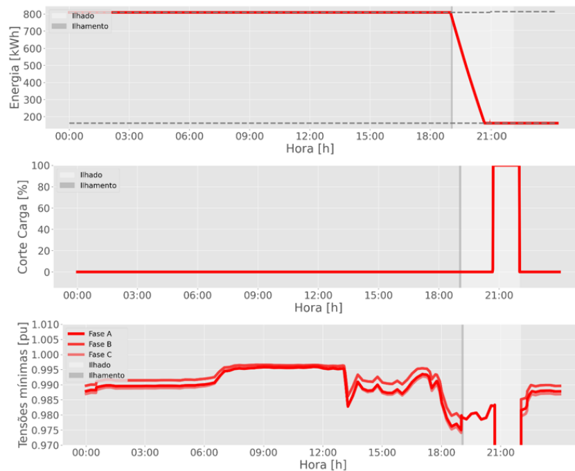
Figura 7 – Energia do BESS, corte de carga e tensões no PAC: caso V e contingência às 19 horas. No cenário V, o BESS inicia a contingência completamente carregado, o que lhe permite suprir integralmente a demanda da microrrede. No entanto, após aproximadamente duas horas e quarenta e cinco minutos, o SoC do BESS atinge o limite mínimo de operação de 20%, conforme estabelecido como critério de segurança. Nesse ponto, o sistema não consegue mais manter o balanço de potência, resultando no desligamento da microrrede para evitar danos ao sistema e perda de estabilidade. Esse cenário demonstra que, mesmo com o BESS em plena capacidade no momento do ilhamento, sua autonomia é limitada pelo nível de demanda das cargas conectadas e pela ausência de fontes de geração complementares, como FV ou geradores térmicos.
