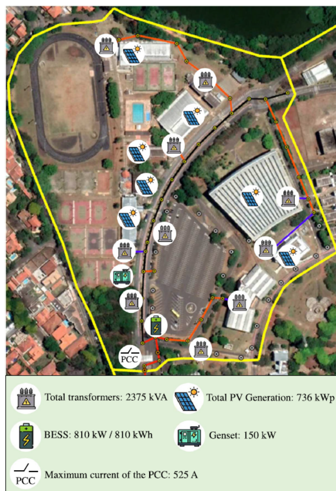
Figura 2 – Microrrede CampusGRID (Silva et. al., 2023).
